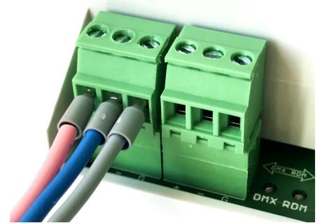
Jeder Klemmanschlußblock verfügt über drei Klemmen für die normmäßige Belegung gemäß USITT DMX512/1990, DIN 56930-2, ANSI E1-11 und ANSI E1-20:
